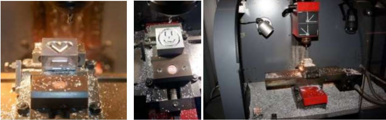
Tehnobussis EMCO arvuti arvjuhtimisega (CNC) lõikuri töölaual detaili loomine
